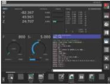
**1.** Visualisierung mehrerer Informationen auf einem einzigen Bildschirm, z. B. Last der Vorschubachsen und Hauptspindel, aktives Programm, modale Funktionen, verwendetes Werkzeug, Icons, Fehlermeldungen usw.
