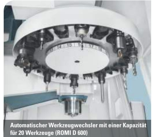
Automatischer Werkzeugwechsler mit einer Kapazität für 20 Werkzeuge (ROMI D 600)
