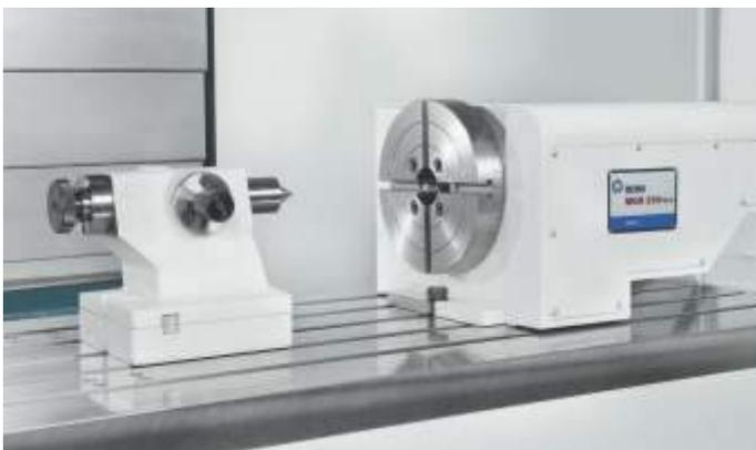
Diese Option ermöglicht die Bearbeitung von Teilen mit beliebigen Winkeln sowie kontinuierlicher Interpolation. Der Tisch gewährleistet eine hervorragende Positionierung und Wiederholgenauigkeit. Die robuste Konstruktion sorgt für Steifigkeit und gute Dämpfeigenschaften. Für die Bearbeitung von langen Teilen kann er optional mit einem Reitstock ausgestattet werden.
