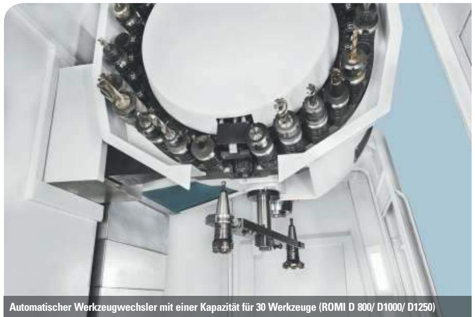
Automatischer Werkzeugwechsler mit einer Kapazität für 30 Werkzeuge (ROMI D 800/ D1000/ D1250)
