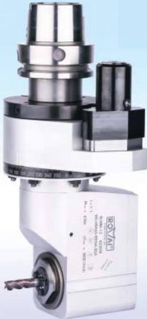
Mit dem BOHRMAX können mit einem Winkelkopf Stirnseiten gefräst, oder genutet werden.
