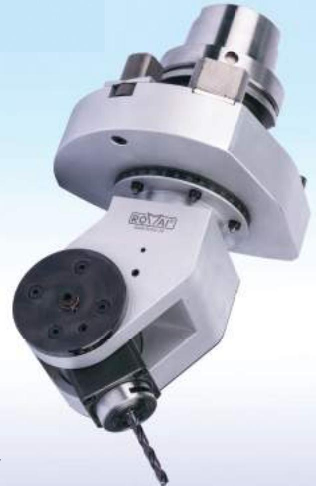
Für den Geländerbau können zusätzlich Löcher schräge gebohrt werden. Mit einem verstellbaren Winkelkopf wird z. B. der Bohrwinkel auf 20° eingestellt. Im Bohrprogramm wird als Bohrwinkel 20° eingetragen.
