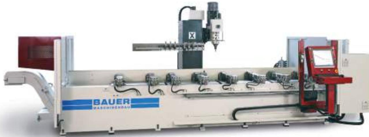
Bohrmax Z 40 mit 8 Stück hydraulischen Schraubstöcken und Pendelbetrieb
