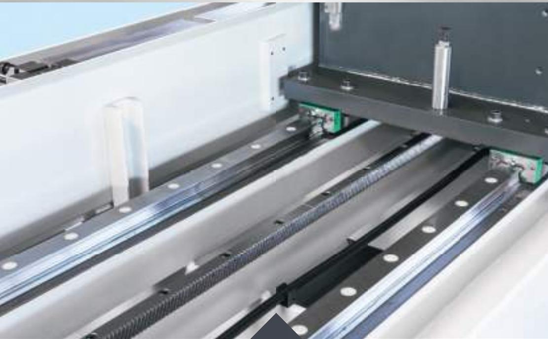
Groß dimensionierte Linearführungen, großer Führungsabstand, Vorschub x-Achse durch geschliffene Schrägverzahnte Zahnstange, Servogetriebe und Servomotor.
