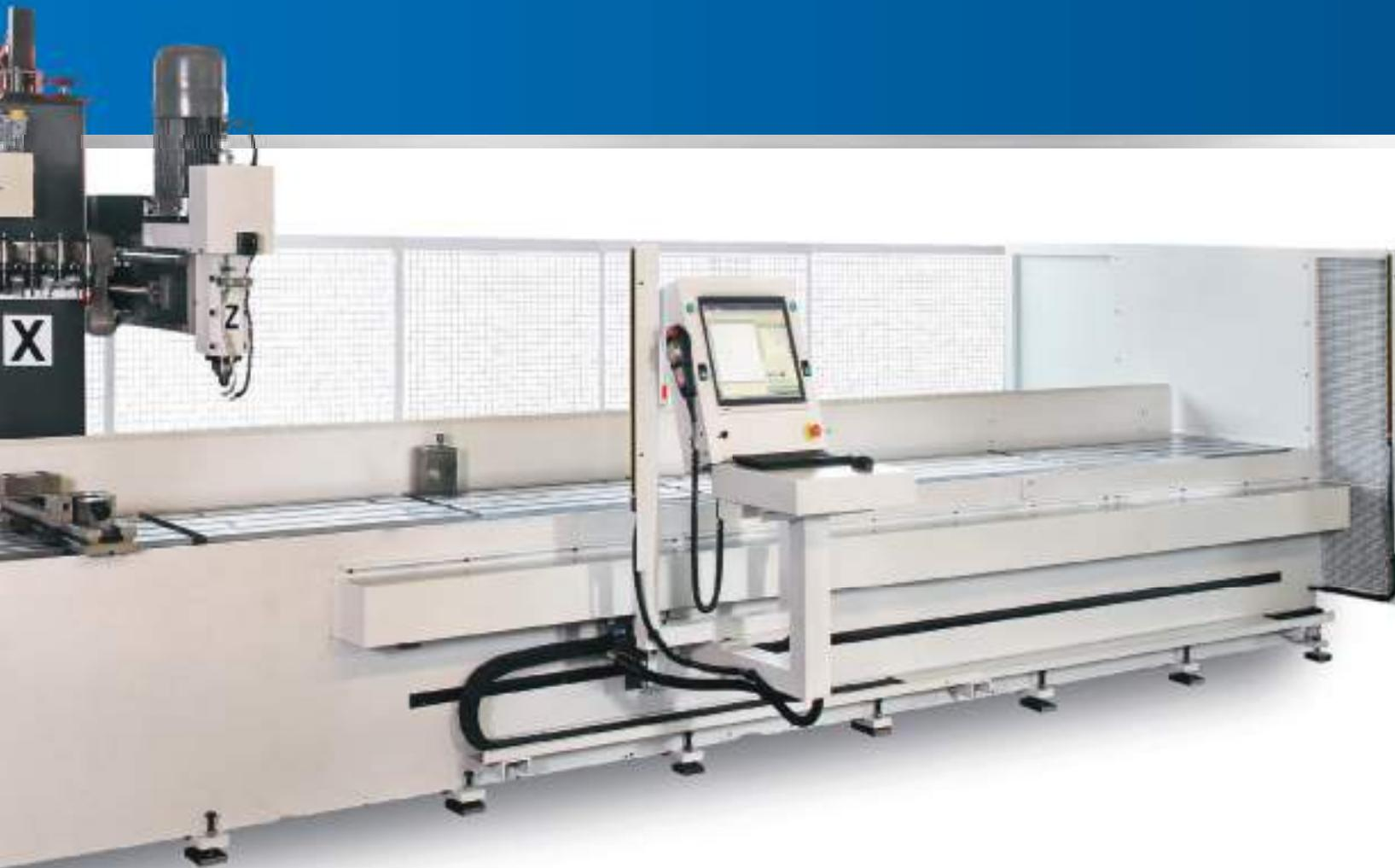
X Achse 8050 mm, Y Achse 580 mm, Z Achse 700 mm
