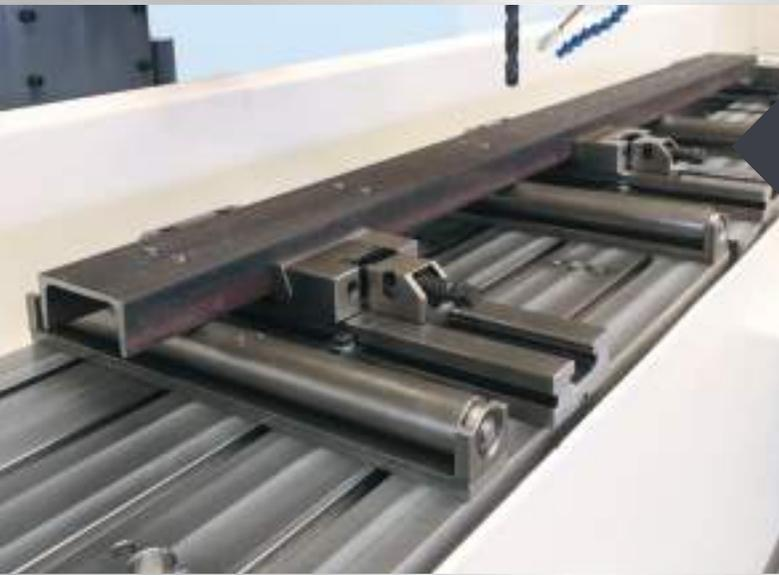
Zum leichteren Verschieben der langen Werkstücke bietet BAUER Rollenböcke an.
