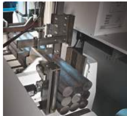
Hydraulische Vollbündelspanneinrichtung zufuhrseitig.
