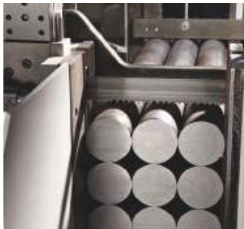
Hydraulische Vollbündelspanneinrichtung abfahrseitig.
