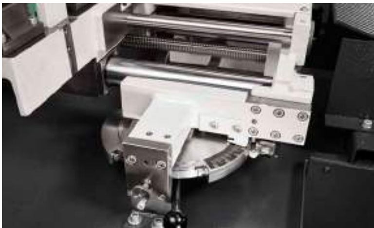
Vorschub ber Kugelrollspindel, Gehrungsverstellung stufenlos.
