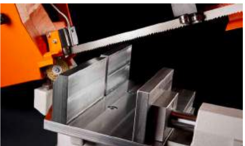
Beidseitig geschlossene Rillenkugellager und Hartmetall-Sägebandrücken-Gleitführung.
