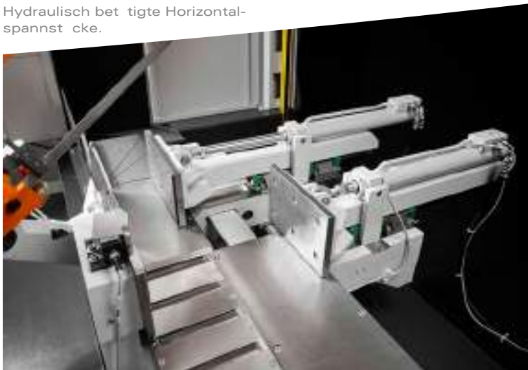
Vorschub ber Kugelrollspindel, Gehrungsverstellung stufenlos.
