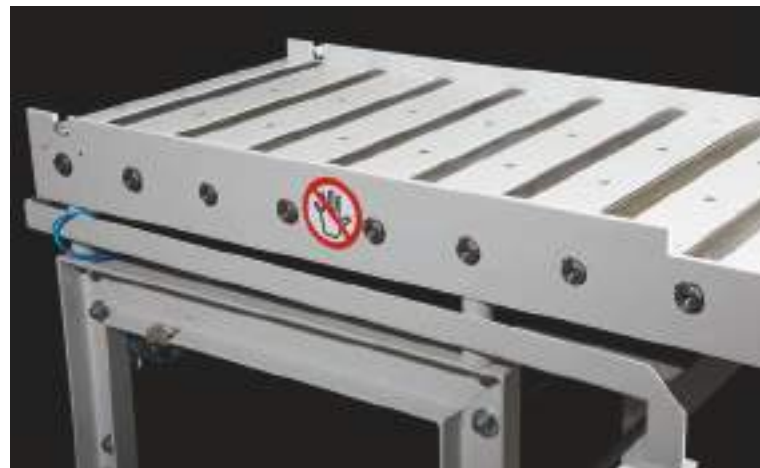
Abfuhrrollenbahn mit einer Nutzlast von 3 t.
