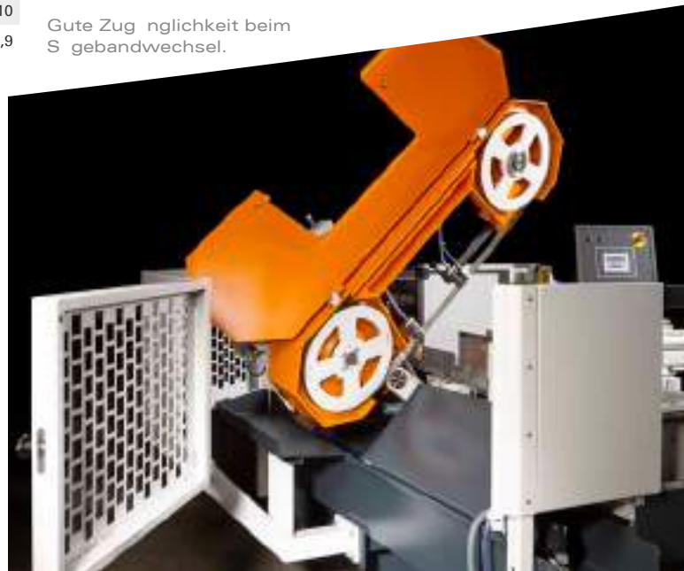
Maschinenverkleidung entsprechend der neusten Maschinenrichtlinien.
