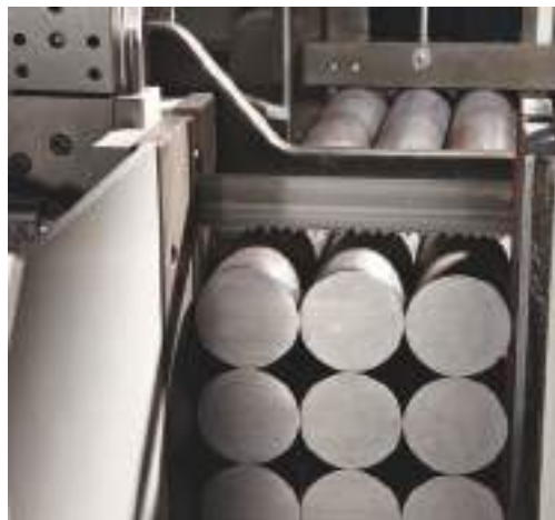
Hydraulische Vollbündelspanneinrichtung abfahrseitig.
