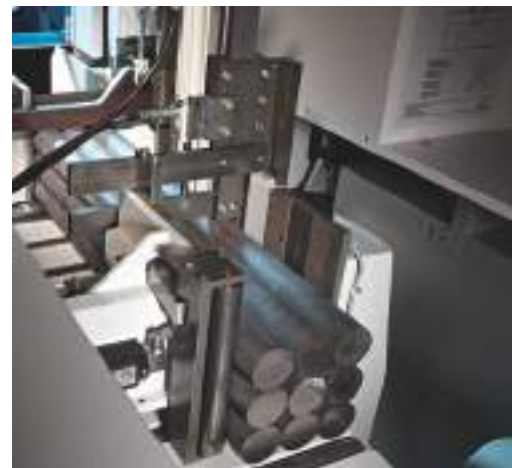
Hydraulische Vollbündelspanneinrichtung zufuhrseitig.
