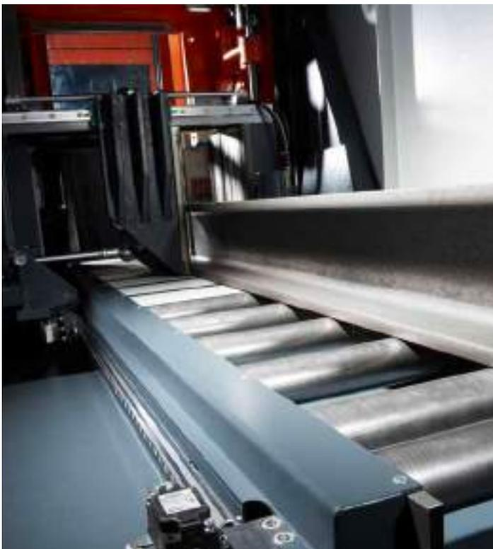
Hydraulische Bandspaneinrichtung inkl. Schließbegrenzung
