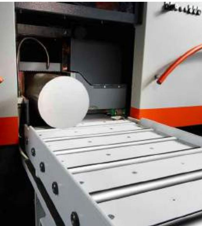
Doppelrollenbahn für automatischen Materialwechsel
