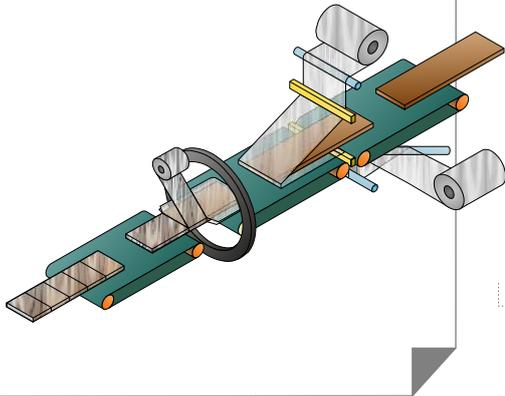
Las instalaciones **COOLPACK-150-EXPRESS** están compuestas por una mesa de entrada, un cabezal de soldadura, una mesa intermedia, una corona giratoria y una mesa de salida.
